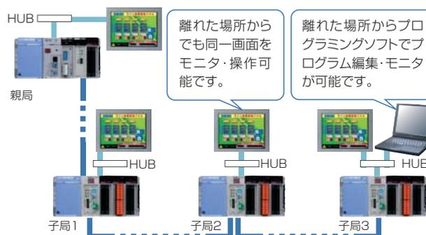
(注)子局のEthernet通信ポートのIPアドレス等の設定は、専用ツールをご用意
