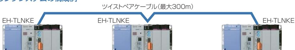
互換モード、標準モードが使用できます。接続台数は互換モード時8台、標準モード時32台までとなります。
