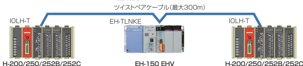
互換モード(低速モード(HS:OFF))の設定で混在使用できます。接続台数は8台までとなります。
